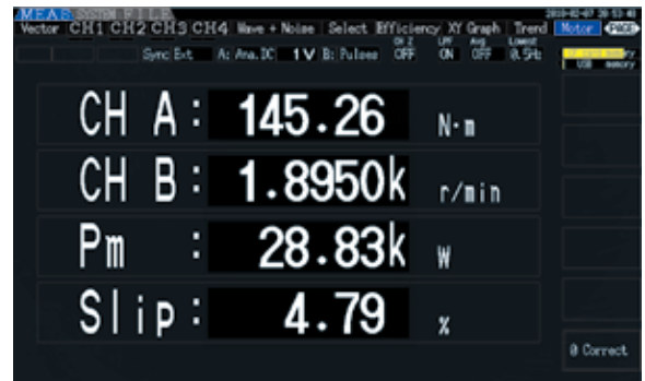
모터해석화면 (토크, 회전수, 모터파워, Slip) CH B 에 인코더의 Z 상 펄스를 입력하면 전기각을, B 상 펄스를 입력하면 회전방향을 측정할 수 있습니다.
